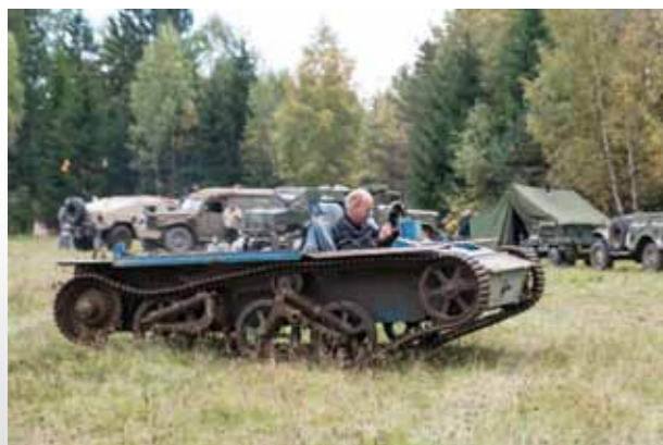
Ford Universal carrier, ble brukt av bønder etter krigen og ofte ble pansringen skjært ned som på denne. Opprinnelig utstyrt med V8 Ford flatåtter. Om denne skapningen ble det sagt; ble brukt til alt, men var ikke brukbar til noe.
