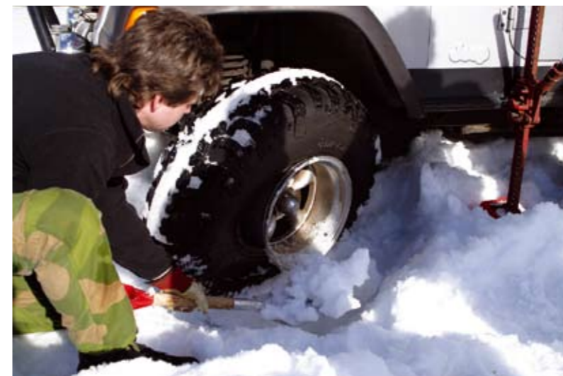
Fastkjørt med et dekk som har løsnet fra felgen. Jekk, spade, startgass pluss noen kompisser fikser det. Vi fant fort ut at det var lettere å måke snø enn myr...
