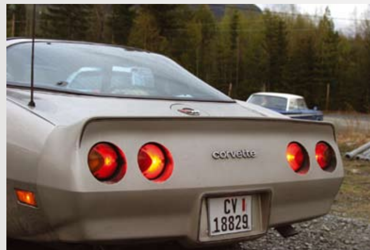
Fiks idé. Bård Roine fra Røn har kommet opp med en løsning for å få riktige farger på baklysene i sin 1982 Corvette. Baklys fra elbilen Think passer rett inn i bakfangeren på bilen.
